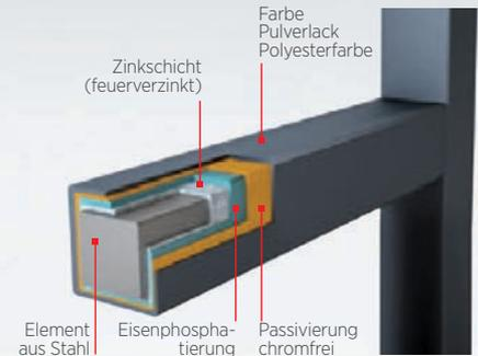
Querschnitt durch das Sicherungselement im System DUPLEX
