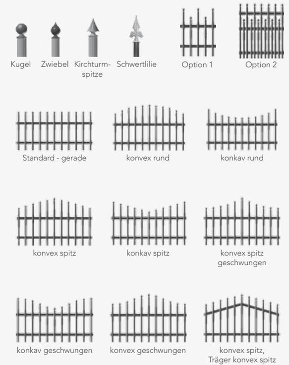
GLORIETTE besteht aus Palisadenstäben mit längsseitigen Zierrillen. Möglich sind auch zusätzliche Stabreihen.
