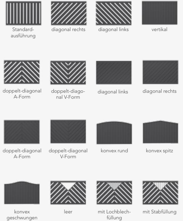
UMBRIA besteht aus verschiedenen Lattenprofilen unterschiedlicher Breite. Verschiedene Füllungsanordnungen und Ornamentvarianten sind möglich.
