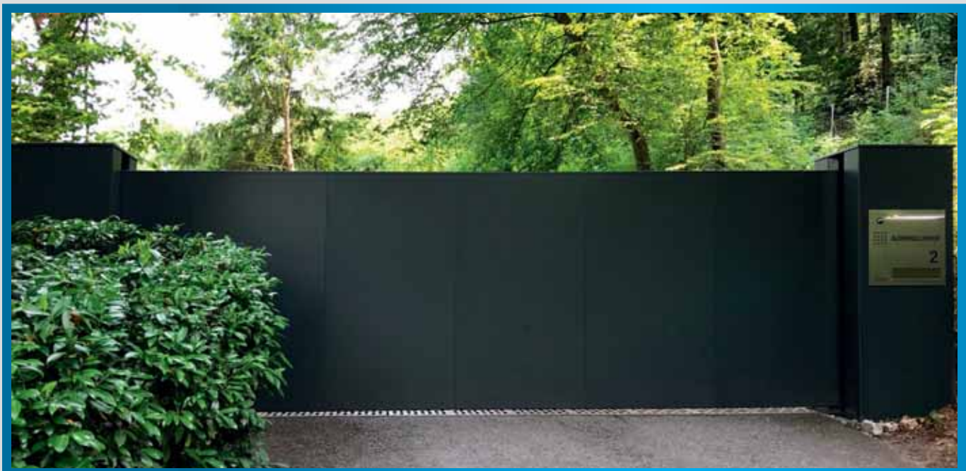
5,9 m Schiebetor, Glattblech beidseitig über die Laufschiene, Halte- und Einlaufpfosten Sonder mit 750 mm Breite, eingearbeitete Fanggabel im Sonder-Einlaufpfosten, RAL 7016
