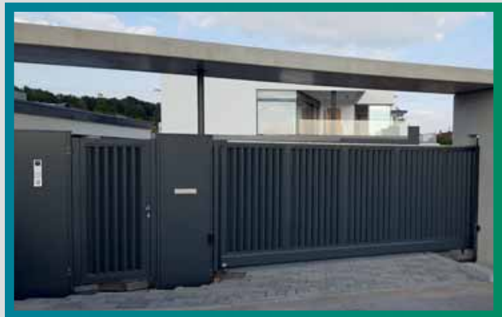
5 m Schiebetor mit Gehür, Lamelle senkrecht im Rahmen, RAL 7016 matt, Inline 100, Anschlussstür mit Sonder-Bedien- und Briefkastensäule als Halte- und Einlaufpfosten
