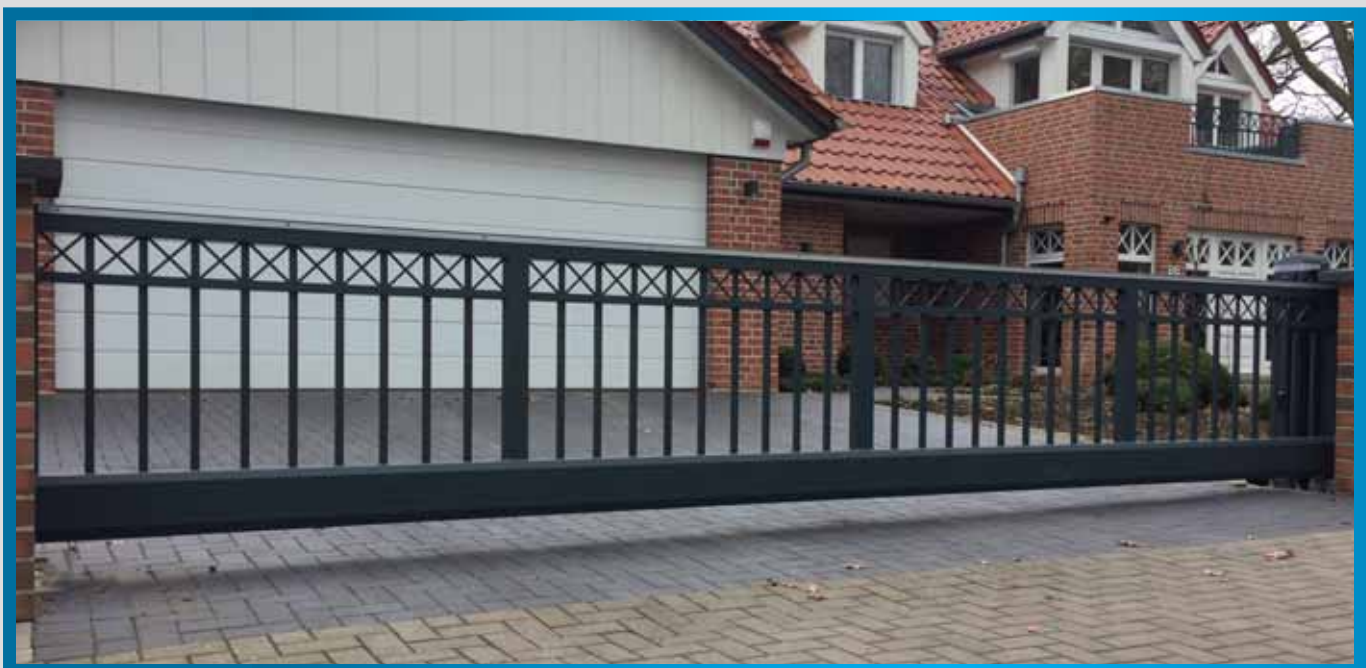
6,2 m Schiebetor, 1,1 m Höhe in RAL 7016 Feinstruktur, Füllung Profil 25x20 inkl. Kreuzornamente, Inline 100
