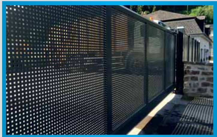
5,50 m Schiebetor, Lochblech 10 x10 mittig im Rahmen, RAL 7016, Haltepfosten PORTAL
