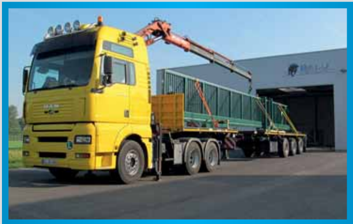
13 m Schiebetor, Transport mit Kranentladung und einteiliger Lieferung
