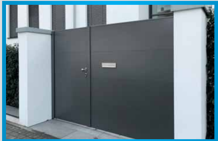
2-flg. Drehtor außermittig geteilt (1,05/1,64m), Füllung Glattblech beidseitig vor dem Rahmen inkl. 3 Stk. Zwischendurchzüge waagrecht in der Höhe
